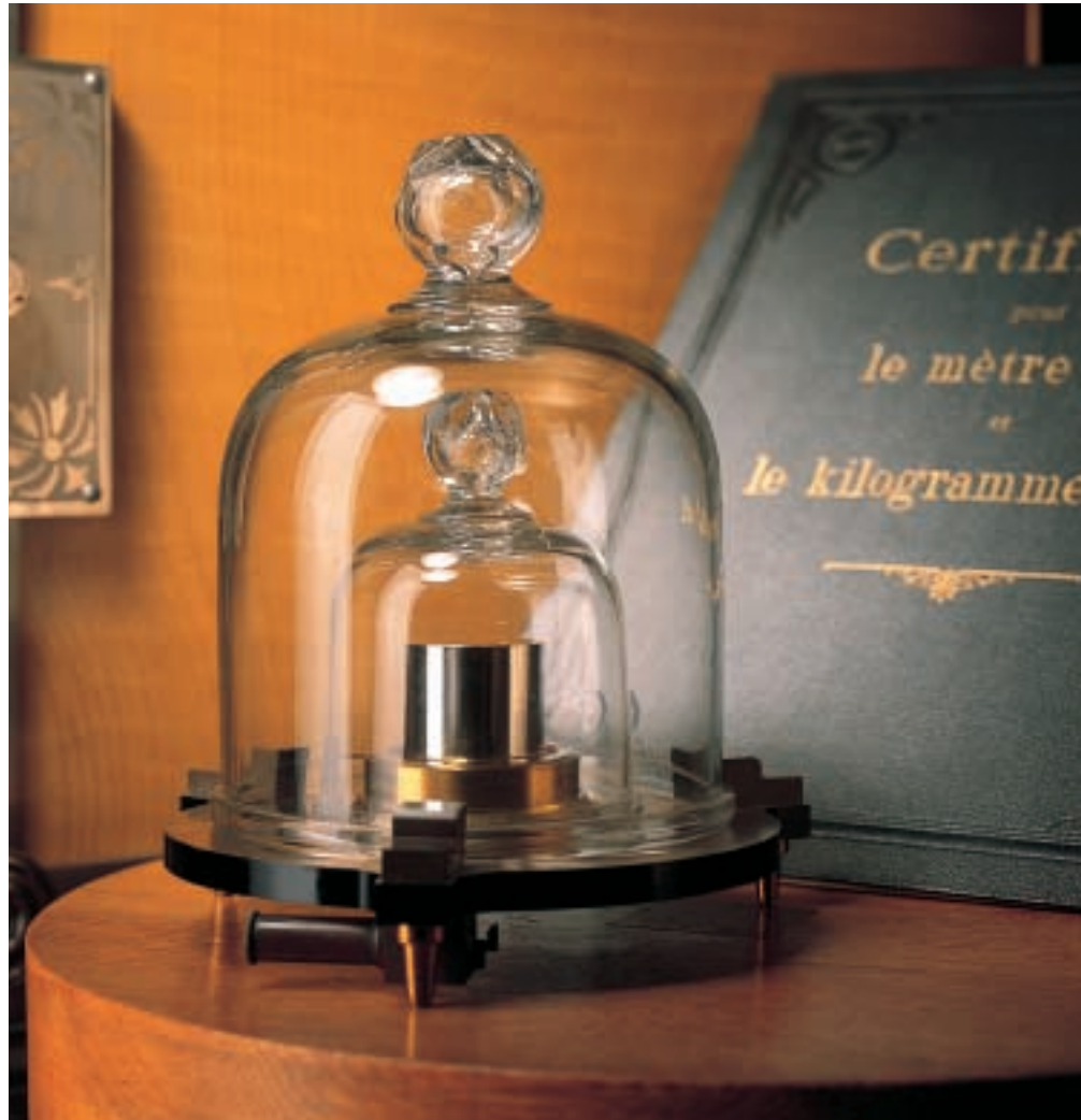
Die Schweizer Kopie des Urkilogramms, der Prototyp Nr. 38
